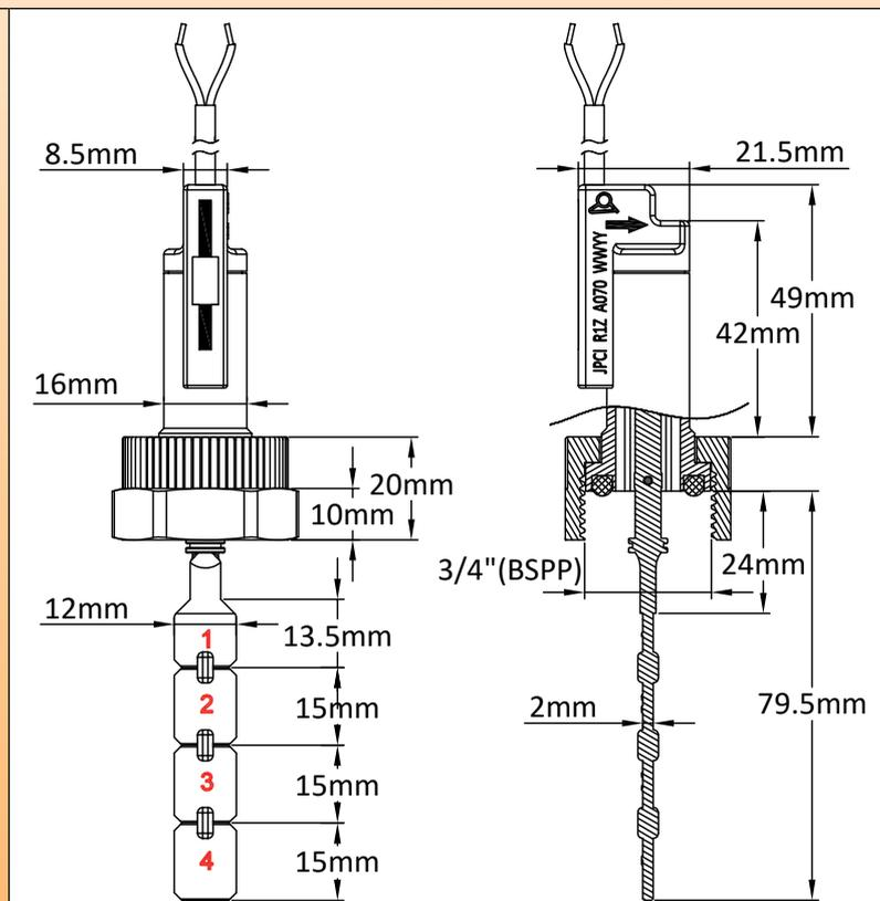
**主要用途:** **大量应用**在低电压电子电路的水流检测。最经济的型号。建议安装位置是在水平的管道上。由于桨叶重量的原因，在校正过程中可以安装在有小流动的任何位置。可用于**直径15至100mm**的水管。
